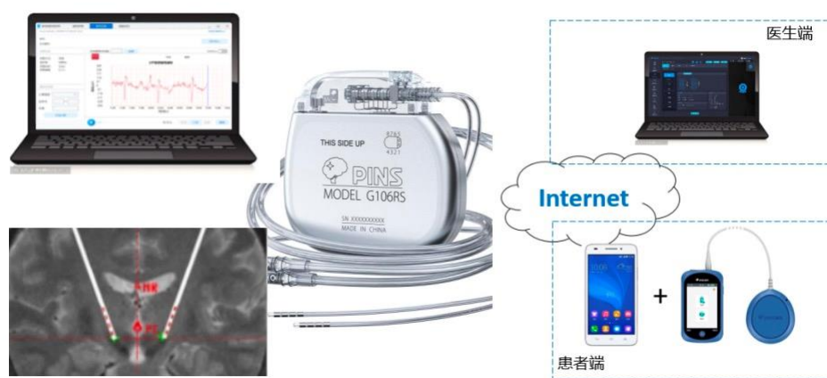
图 41：品驰公司 AI+ MRI 兼容的蓝牙可感知 DBS 系统
